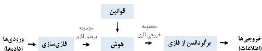
شکل (۱): ساختار کلی سیستم فازی
